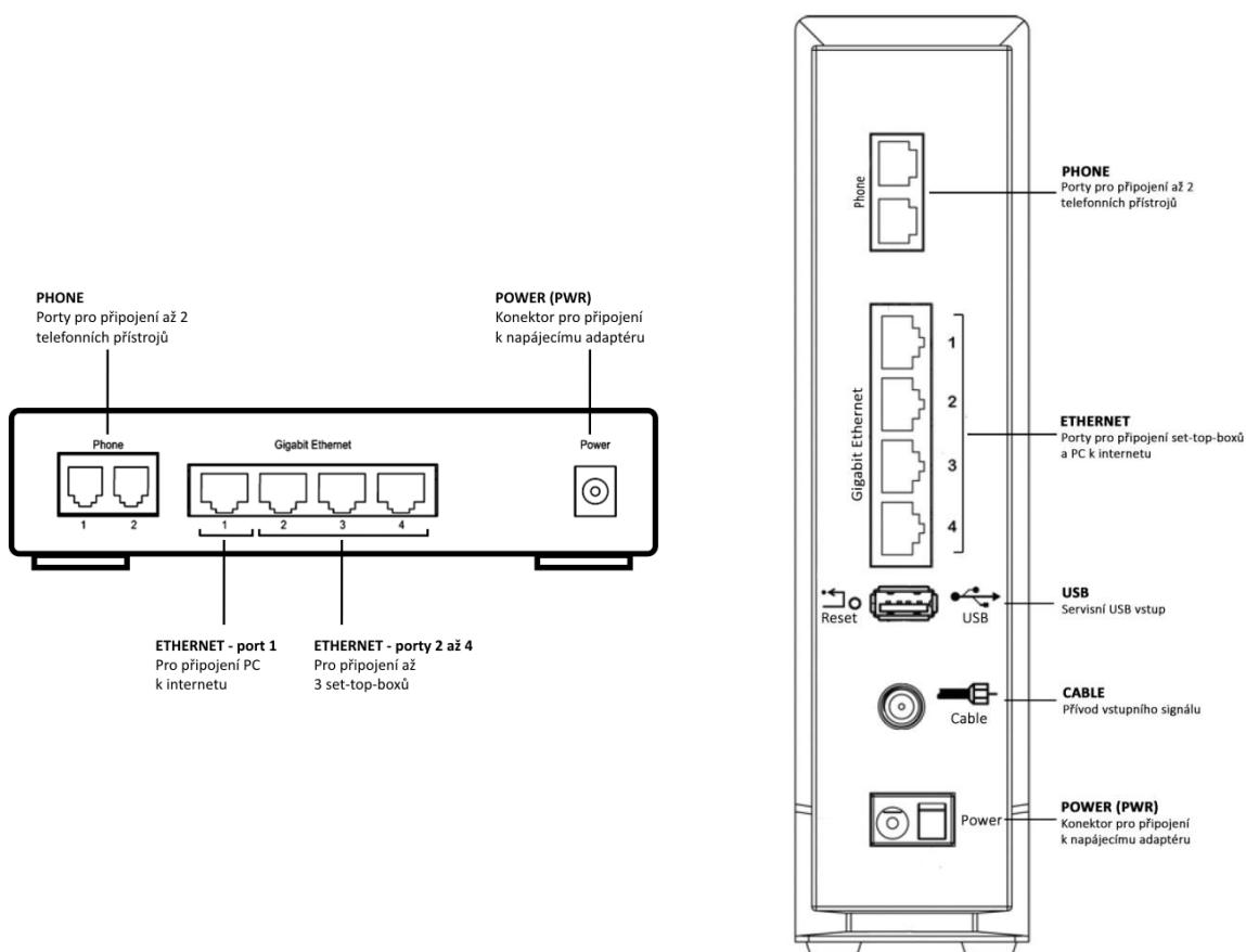
Obr. 2: Zobrazení a popis portů na zadním panelu gateway (vlevo) a modemu (vpravo).
