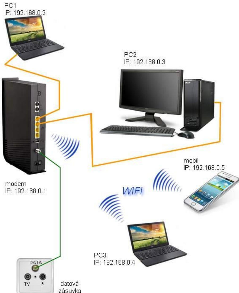
Obr. 2 Zapojení modemu do sítě
